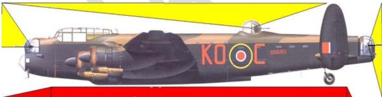
L'AVRO LANCASTER Mk II est un bombardier lourd sorti en 1943. Fabriqué par A.V ROE & Cie Ltd il est motorisé avec 4 moteurs BRISTOL HERCULES de 1735CV. Seulement 300 exemplaires seront construits. Ce bombardier pèse plus de 28 tonnes, il a une autonomie de 3620 km et a une vitesse maxi de 426km/h à 4300m. Il peut atteindre une altitude de 5650m. Avec une envergure de 31,09m il est long de 21,18m pour une hauteur de 6,25m.
